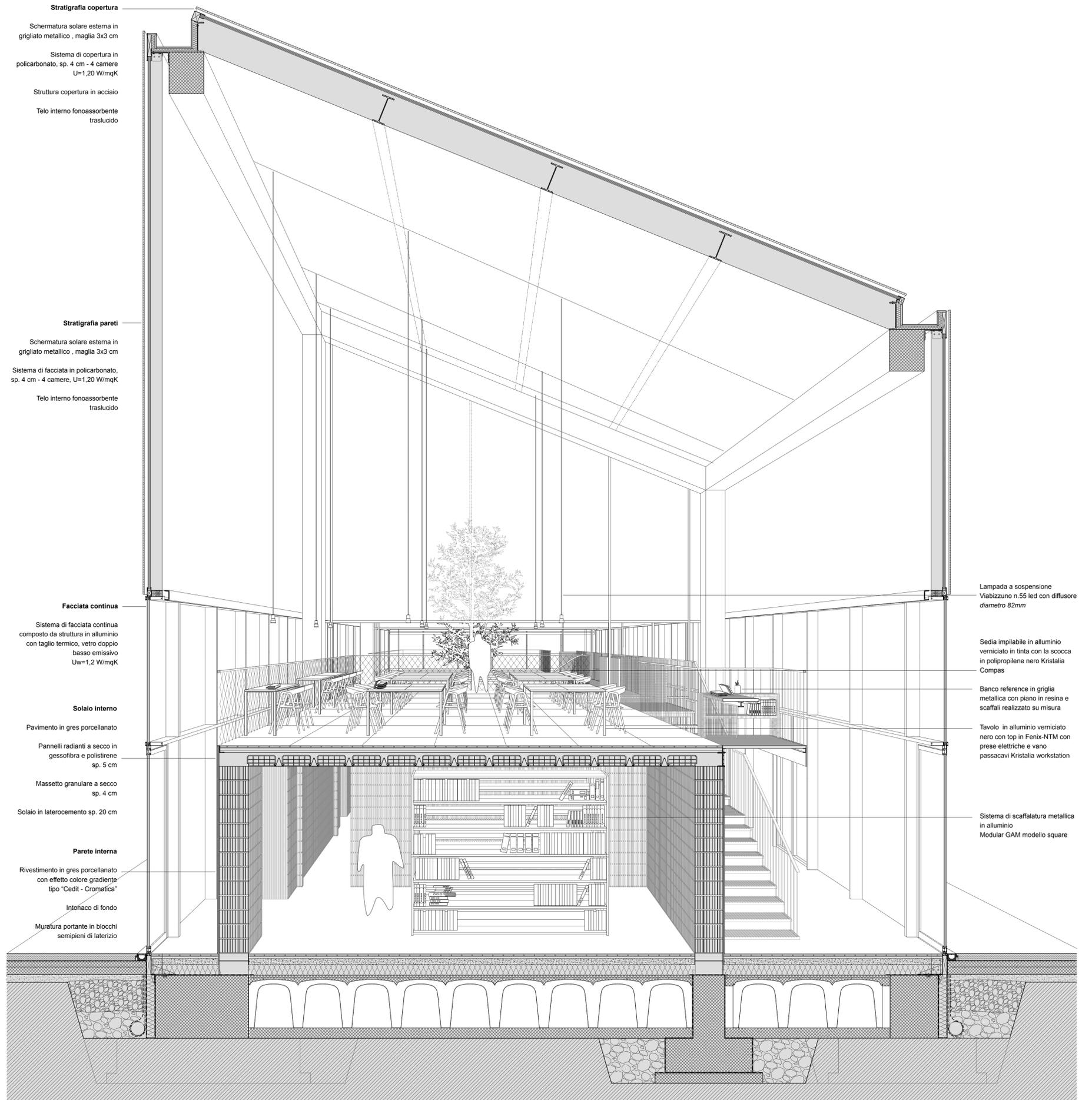
Dettaglio costruttivo dell'edificio e degli arredi su misura - Scala 1:30
