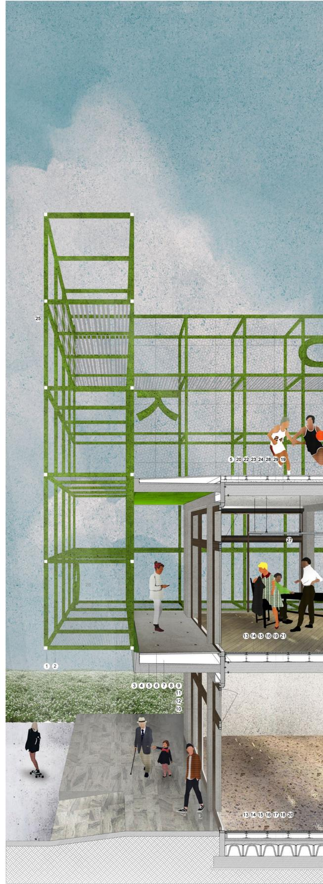
1. Struttura in carpenteria metallica composta da scatolari quadrati 10X10 in acciaio zincato verniciato
