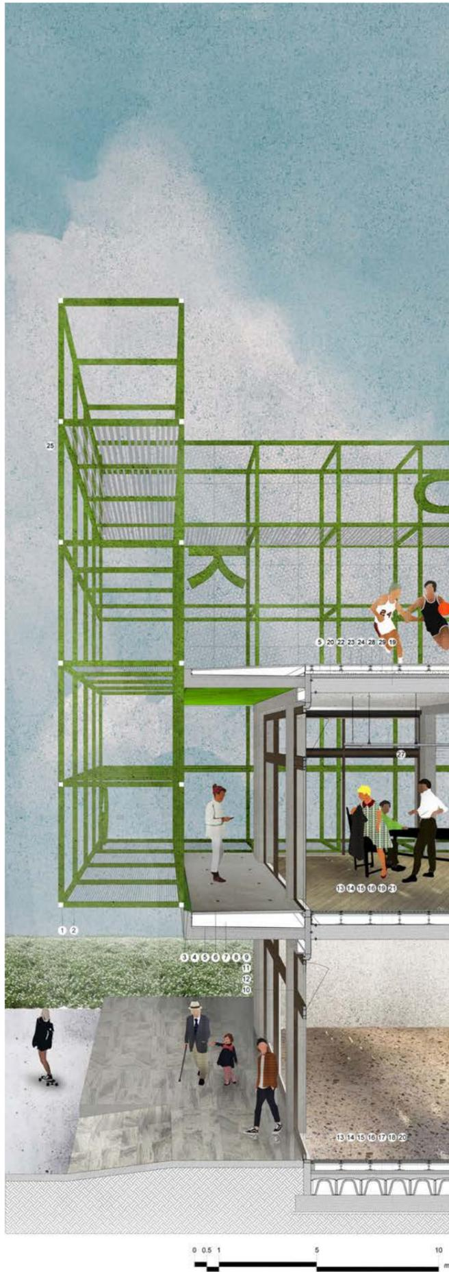
1. Struttura in carpenteria metallica composta da scatolari quadrati 10X10 in acciaio zincato verniciato
