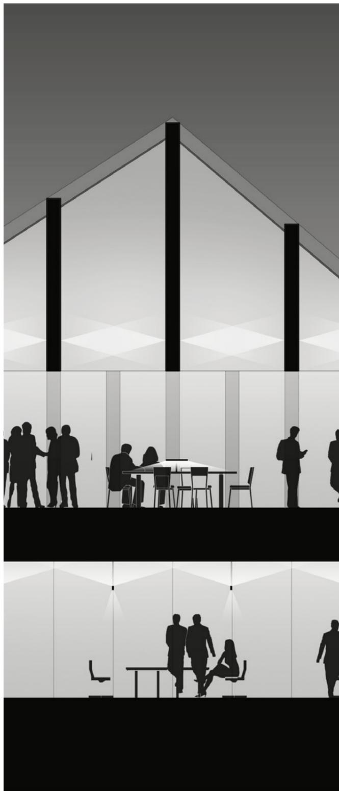
A destra: Schema dei sistemi di illuminazione ad emissione diretta e indiretta
